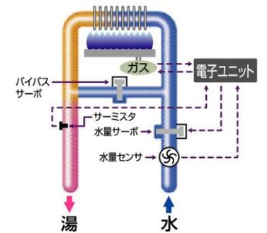
バイパス回路に流れる水量をステッピングモーターで調節することで出湯性能を向上させ、設定温度までの到達時間の短縮や再出湯時の不快な湯音の変化を押さえる進んだ湯温制御方式です。
