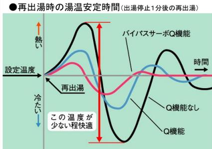
お湯の使用をいったん停止したあと再び出湯させると、最初は熱いお湯が出て、続いて一時的に冷たい水が出ます。「Q機能」は、再出湯直後のお湯の温度差を最小限に抑え、断続使用時でも快適にご利用いただくための機能です。
